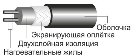
Рисунок 3 – Устройство нагревательного провода.
