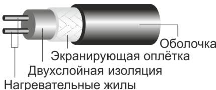
Рисунок 3 – Устройство нагревательного провода.
